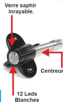
Equipée d'un capteur Sony CCD 480TVL, la caméra dispose d'un angle de vue de 135°. Son diamètre de 23mm et sa longueur de 120 mm ressort inox compris lui permet de passer un coude de 90° dans un diamètre de 45 mm.
