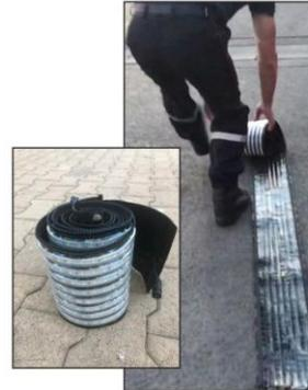
Un manchon constitué de bandes à leds étanches est déroulé puis emmanché sur un mât déroulable ROLATUBE. L'ensemble est fixé au véhicule par quatre semelles magnétiques
