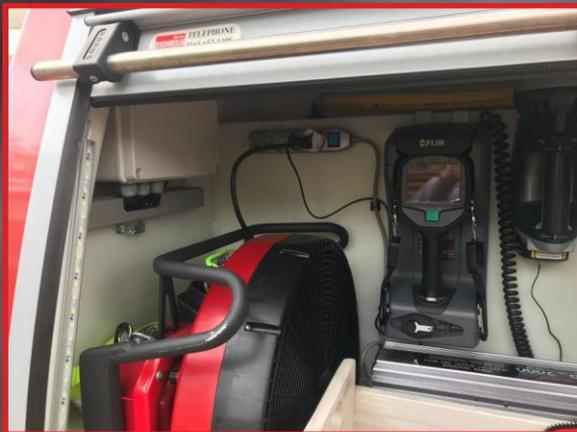
Les ventilateurs Quickee et Commando peuvent être laissés en charge permanente sur les véhicules équipés de prises 220V.
