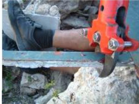
Il ne faut que quelques secondes à l'opérateur pour découper un châssis de fenêtre abattu sur une victime. La coupe a lieu en silence, sans étincelles, sans vibration et sans source d'énergie lourde et encombrante. Qu'il s'agisse d'une huisserie dans un sous-sol ou d'un châssis de véranda au dernier étage, l'intervention a lieu dans des conditions optimales...
