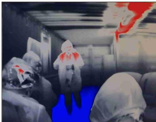
Une ou plusieurs caméras thermiques FLIR durcies positionnées à l'extérieur du caisson permettent le suivi de l'évolution des stagiaires dans le caisson avec enregistrement sur un PC dédié : outre une fonction de surveillance, l'enregistrement constitue un apport pédagogique très apprécié par les formateurs lors du débriefing après une séance de formation. Le capteur 320X 240 et l'angle de vue de 49° donnent une excellente image même par fumées épaisses.
