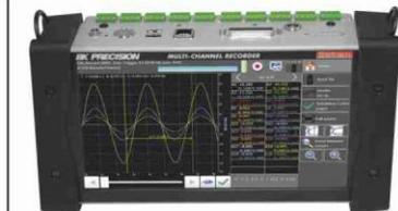
La centrale d'acquisition permet de visionner sur un écran couleur tactile de 10 pouces et sous différentes formes (courbes et/ou valeurs numériques) les températures mesurées par les thermocouples.
