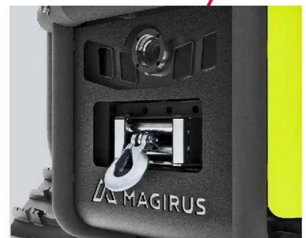
Avec une force de traction allant jusqu'à 4 T, le Wolf R1 est une véritable centrale électrique.
