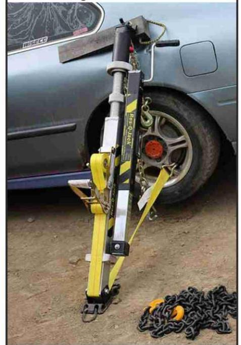
La tête peut être changée rapidement en retirant une simple goupille de verrouillage. Elle est fournie en standard avec notre tête tournant à 360° pour un placement précis sur n'importe quel point d'accroche.
