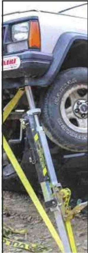
Passage de la fonction stabilisation au levage en quelques secondes grâce au treuil manuel additionnel.
