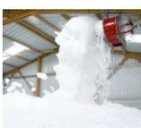
**PROSINTEX A** peut être utilisé avec des différents types de générateurs de bas foisonnement et moyen foisonnement
