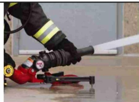
La buse d'attaque rapide RAN à débit réglable modèle 3895 utilisable avec le RAM XD permet à l'utilisateur de choisir entre 3 débits : 1900 LpM, 1 300 LpM, et 950 LpM à 5 bars.
