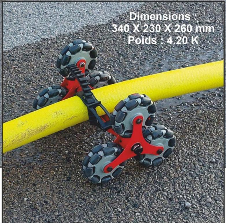
Désolidarisation des roues et de l'axe support par simple pression sur les boutons poussoirs.
