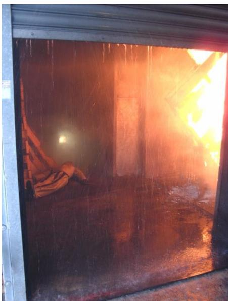
Ces mannequins ont été conçus pour résister à des températures de 140 à 160°C représentant la température moyenne au sol dans les centres d'entraînement au feu et commencent à se dégrader lorsque la température excède 180°C.
