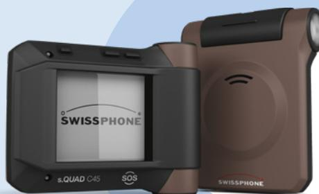
Les nouveaux terminaux radio **s.QUAD C** combinent le design avant-gardiste et les caractéristiques de performance uniques des anciens récepteurs de radiomessagerie s.QUAD avec un canal de communication mobile supplémentaire. L'alarme continue à être transmise en premier lieu par la technologie POC-SAG fiable et éprouvée. De plus, le s.QUAD C peut également être alarmé via le réseau mobile (alarme hybride) et offre la possibilité d'un retour d'information sous différentes formes :
