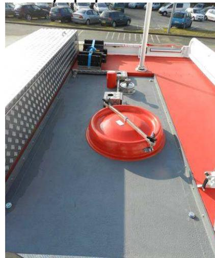
**Cuve (EAU - EMULSEUR et/ou MOUILLANT) en COMPOSITE**
