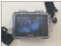
Le moniteur-récepteur-enregistreur peut être visualisé tel quel ou protégé dans un boîtier étanche et anti-choc ou sur un support de poignet (en option).
